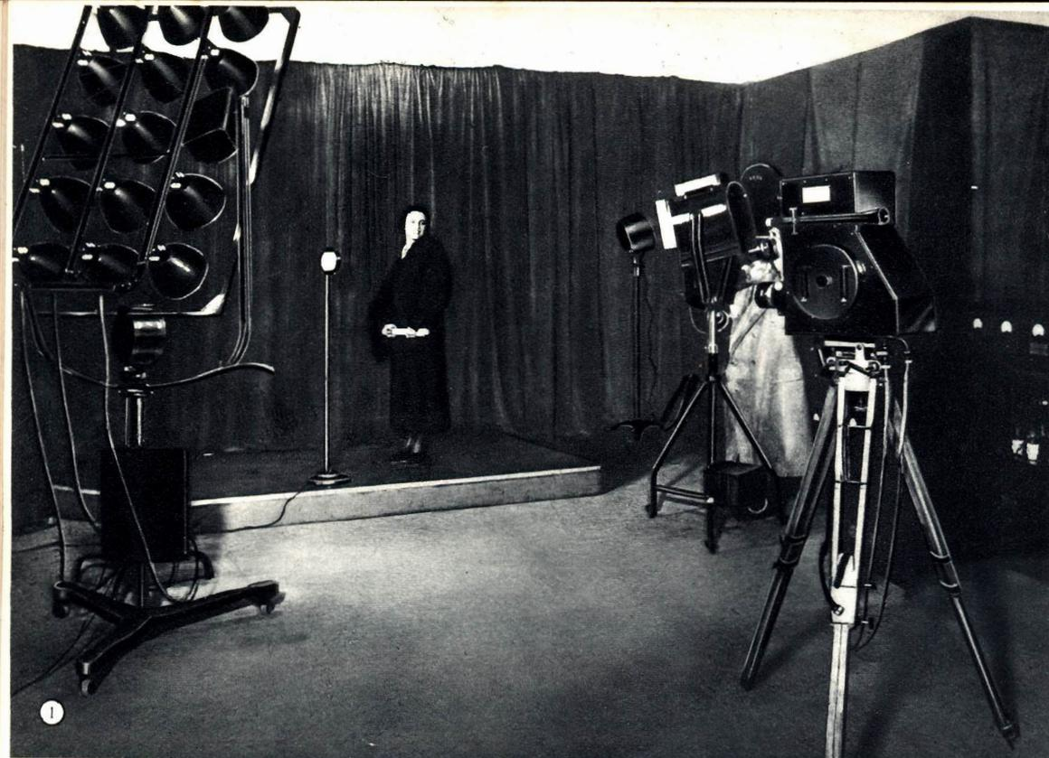
1. — PROVE DI TELEVISIONE DA INTERNO CON TELECAMERA — In primo piano la telecamera; più in fondo tutti gli accessori per la trasmissione da studio. Lateralmente sono disposti gli amplificatori dai quali gli "impulsi immagine", convenientemente amplificati, vengono inviati al radiodiffusore ad onda ultracorta.
