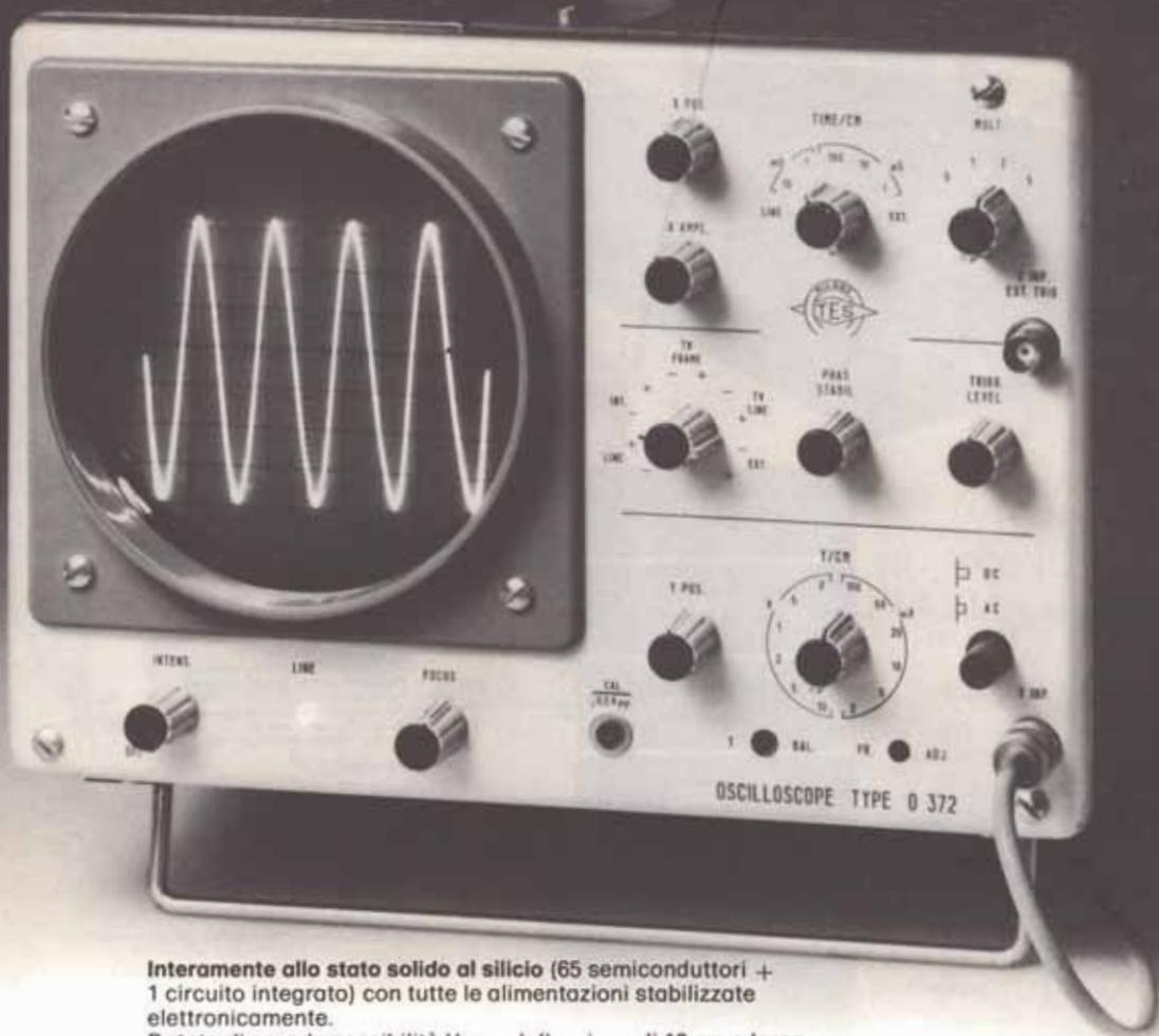
**Interamente allo stato solido al silicio (65 semiconduttori + 1 circuito integrato) con tutte le alimentazioni stabilizzate elettronicamente.**
