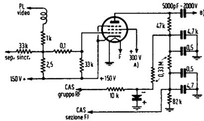
Fig. 106 — Stadio relè (« gated ») per il CAS. A = collegamento della griglia schermo: fa capo direttamente al circuito (fare attenzione che il livellamento di questo sia sufficiente). B = connessione all'avvolgimento del trasformatore d'uscita orizzontale. In caso di ir-
