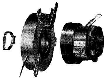
Fig. 28 — Giogo, bobina di fuoco, centratore e magnete trappola-ionica del commercio.
