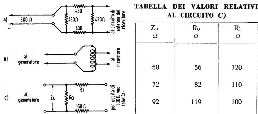
Fig. 86 — Attenuatori e adattatori. Leggenda: A = attenuatore disaccoppiatore da inserire tra antenna e ricevitore. B = adattatore d'impedenza per generatore campione, ad autotrasformatore toroidale. C = adattatore d'impedenza a resistenze. Con il disaccoppiatore A è possibile collegare più ricevitori alla medesima antenna.
