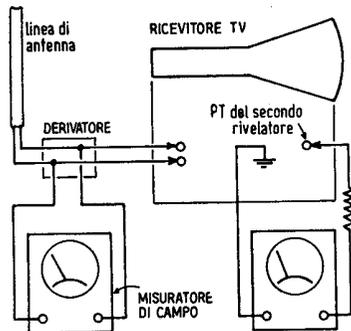
Fig. 105 — Valutazione approssimativa della sensibilità di un ricevitore TV. Il rilevamento è solo parziale e riguarda il rapporto tra tensione indicata dal misuratore di campo applicato all'antenna (può essere tenuto collegato mediante un circuito disaccoppiatore) e tensione continua prodotta nel circuito del secondo rivelatore. Tale rapporto, che varierà evidentemente tra i diversi tipi di ricevitore, non tiene conto, dunque, del
