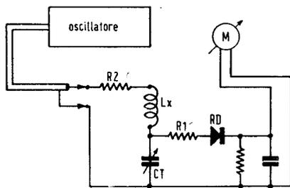
Fig. 23 — Collegamenti per il controllo di una bobina mediante l'oscillatore campione e un rivelatore, in questo caso costituito dal microamperometro M e dal rettificatore RD. R<sub>2</sub> può essere di  $5K \div 10K$  ohm; R<sub>1</sub> di  $10K$  ohm. CT è un microcondensatore tarato di 50 pF max. La misura può essere fatta nel campo compreso tra
