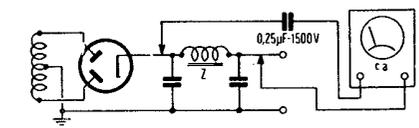
Fig. 92 — Misura della componente alternata esistente tra i capi di una prima impedenza di livellamento  $Z$ . La portata dello strumento deve essere relativamente elevata se l'entrata del filtro è a sola impedenza, dato che questa, in tal caso, ha sempre una componente alternata di notevole valore. Per le impedenze successive il rilevamento richiede generalmente l'uso di un amplificatore di BF. Questi rilevamenti vengono fatti solo in sede di studio o in casi eccezionali.
