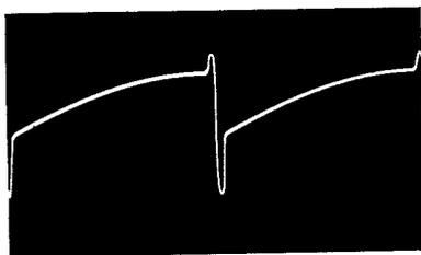
Fig. 31 — Forma della tensione esistente nel circuito di GRIGLIA controllo dell'oscillatore VERTICALE.
