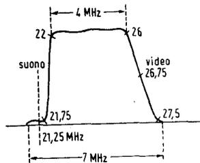
Fig. 12 — Curva ottima di risposta dell'amplificatore di frequenza intermedia "intercarrier" come risulta visibile sullo schermo dell'oscilloscopio, per una FI di 20 ÷ 28 MHz, ottenuta con un complesso di altissima qualità. Sono chiaramente indicati i punti da controllare col marcatore (« marker »). Le curve più at-
