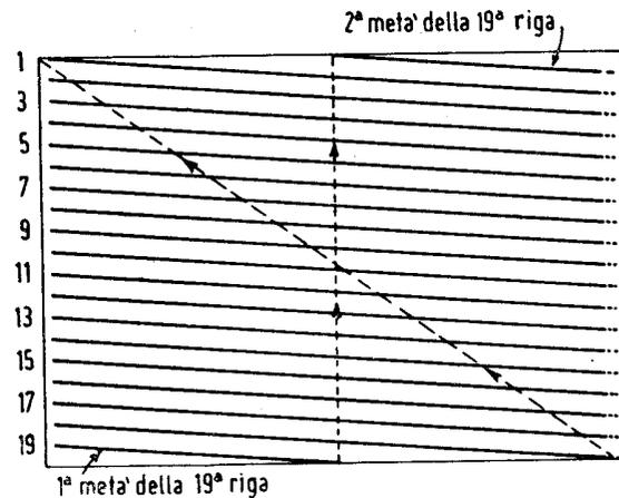
Fig. 2 — La interlacciatura delle righe di scansione consiste nell'analizzare l'immagine prima secondo le righe dispari in cui è divisibile l'immagine, poi secondo le righe pari (o viceversa). In questo modo ogni immagine-fotogramma viene analizzata in due riprese e le 25 immagini-fotogramma che devono essere analizzate in ogni secondo richiederanno « 50 quadri » diversi. La frequenza di scansione di quadro, perciò, sarà di 50 cicli al secondo.
