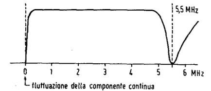
Questo inconveniente si cerca di ridurlo a proporzioni tollerabili creando il così detto gradino del suono, facendo in modo, cioè, che la portante-suono venga a trovarsi in una porzione di gamma per la quale si abbia un'amplificazione lineare pari a circa il 10 % dell'amplificazione massima del segnale video. In pratica, naturalmente, non si riesce mai ad ottenere un gradino ideale e ci si contenta di quello disegnato nella fig. 10, che dà risultati soddisfacenti.
