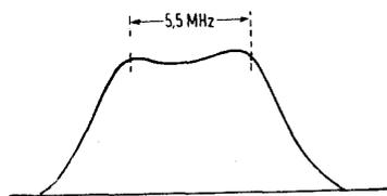
Fig. 16 — Curva di risposta ottima di un gruppo RF. Tale curva deve consentire il passaggio integrale della curva di risposta della sezione a frequenza intermedia, ed è raffigurata come deve risultare all'uscita della sezione RF. In pratica, per la messa a punto di un ricevitore, si rileva solamente la curva risultante all'uscita della sezione FI.
