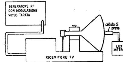
Fig. 104 — Schema d'impostazione per il rilevamento del rapporto tra segnale entrante nel circuito d'antenna di un ricevitore e luminosità resa dal tubo RC (contrasto tra bianco e grigio). Questa misura è molto delicata poiché deve essere effettuata tenendo conto di fattori secondari non sempre agevolmente
