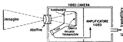
mezzo del fascetto elettronico, il quale si sposta su tutta la superficie attiva secondo modalità e alle frequenze di analisi prestabilite, che dovranno essere rispettate anche nel ricevitore.
