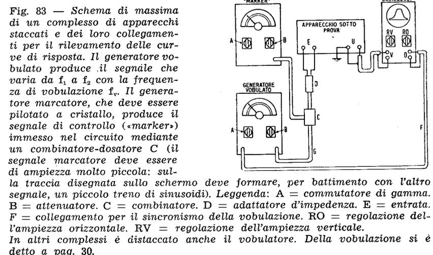
vobulazione (che di solito è di 0,02 sec.) ed è assai lenta. Nel caso del controllo dell'amplificatore video, invece, è da interporre sempre il probe RF, dato che qui effettivamente siamo in presenza di tensioni che hanno frequenze variabili da 0 a 6 e più MHz, e che quindi devono essere rettificare.
