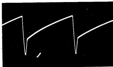
Fig. 33 — Forma della tensione esistente nel circuito di GRIGLIA controllo della valvola di uscita VERTICALE. Valore di picco = 80 ÷ 120 V pp a seconda della valvola usata e del circuito.
