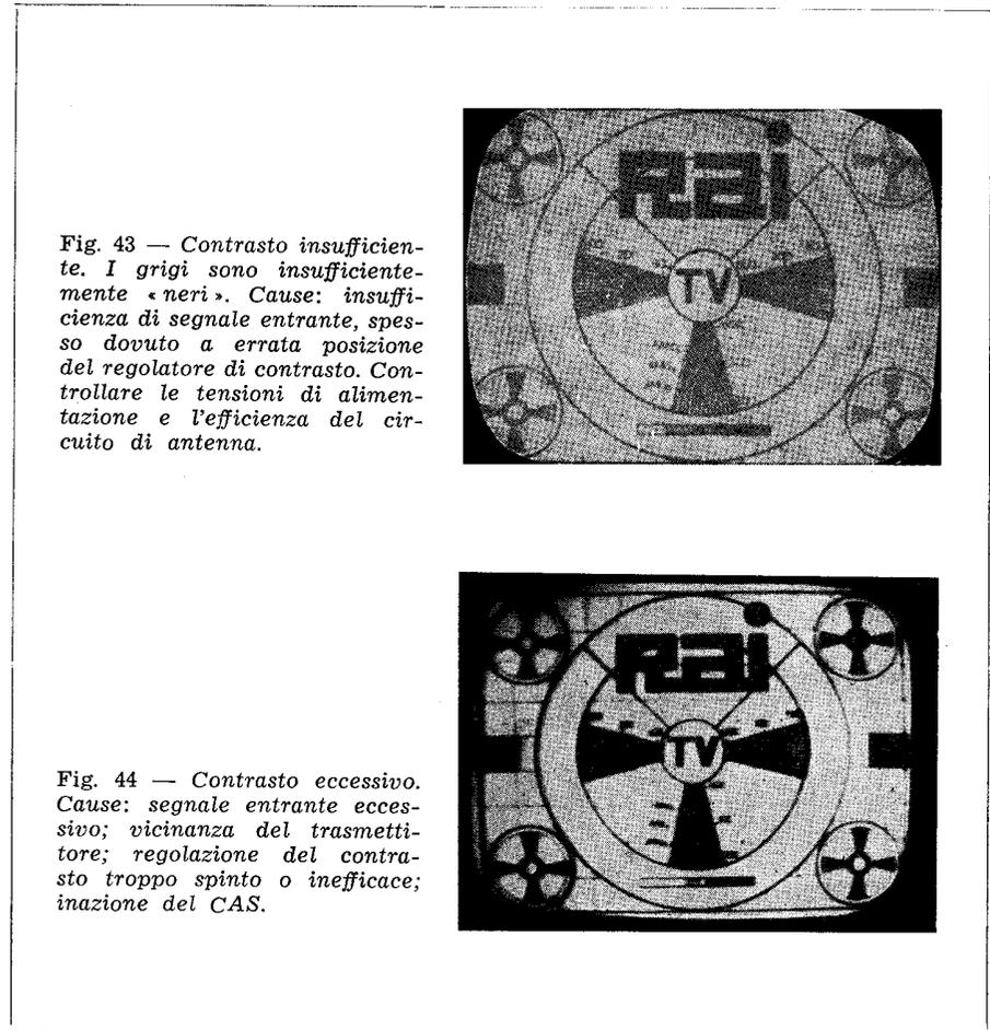
Fig. 43 — Contrasto insufficiente. I grigi sono insufficientemente « neri ». Cause: insufficienza di segnale entrante, spesso dovuto a errata posizione del regolatore di contrasto. Controllare le tensioni di alimentazione e l'efficienza del circuito di antenna.
