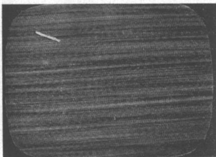
Fig. 46 — *Assenza di sincronismo orizzontale. Cause: errata posizione del regolatore di sincronismo orizzontale. Vedi anche caso n. 25, pag. 97.*
