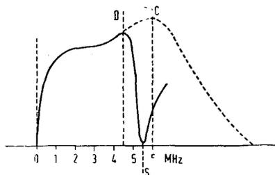
MHz è dovuto all'assorbimento prodotto del trasformatore di accoppiamento con la sezione del suono (che in questo caso funziona a 5,5 MHz). Il sostegno delle bobinette di compensazione è chiaramente indicato anche dal fatto che la curva di risposta tende a riprendere ampiezza oltre i 5,5 MHz.
