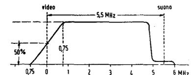
cioè fino a 4,75 MHz. Delle due bande laterali di modulazione che ne risulterebbero, però, una, quella situata nella parte della gamma corrispondente alle frequenze più basse, è parzialmente soppressa: di essa, cioè, sono tagliate fuori tutte le frequenze al di là degli 0,75 MHz (modulati). Questo fatto ha una spiegazione che non è qui il caso di esporre.
