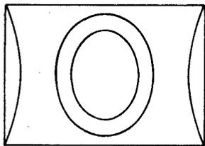
Fig. 41 — Aberrazione geometrica a « guancialetto » dell'immagine. Con questa aberrazione l'immagine mentre è soddisfacente al centro, e qui le linee rette del monoscopio sono rette e s'incontrano ad angolo retto, diviene sempre di più aberrata a mano a mano che si va verso il margine del « formato », assumendo
