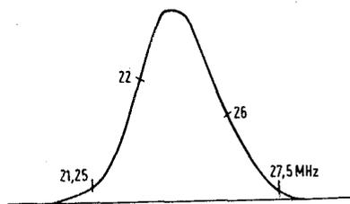
Fig. 15 — Quando una curva è troppo appuntita (e spesso ciò genera oscillazione, visibile sullo schermo dell'oscilloscopio come un segnale di ampiezza molto elevata e occupante nella gamma una banda ristrettissima) vuol dire che più di un trasformatore interstadiale è sintonizzato intorno alla stessa fre-
