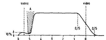
Fig. 11 — Curva teorica di risposta come dovrebbe risultare all'uscita dello stadio video finale. Il sostenimento delle frequenze più alte è ottenuto con le così dette bobine di compensazione. Il « buco » a 5,5 MHz è prodotto dall'assorbimento del trasformatore che invia il segnale alla sezione del suono.
