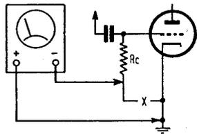
Fig. 90 — Misura della tensione componente continua esistente tra griglia e catodo di una valvola oscillatrice, mediante l'inserimento di un misuratore di corrente (milliamperometro o microamperometro) nel circuito della resistenza di carico  $R_c$ . In questo caso:  $V = I \times (R + R_c)$  in
