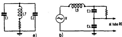
Fig. 21 — Circuiti equivalenti: a) del circuito di griglia dello schema fig. 18; b) del circuito di uscita dello stesso schema.  $C_1$  è la capacità della rivelatrice.
