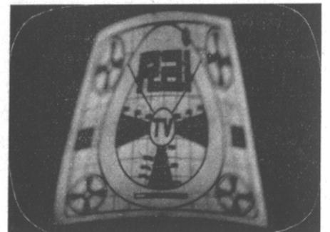
Fig. 62 — Difetto del campo di scansione orizzontale. Cause: difetto nelle bobine di scansione per corti circuiti, deformazioni meccaniche, spostamento di spire. Vedi caso n. 17, pag. 94.
