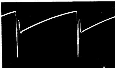
Fig. 32 — Forma della tensione esistente nel circuito di PLACCA dell'oscillatore VERTICALE. L'ampiezza massima varia da circa 150 a 250 V pp (misurabile anche con oscilloscopio tarato) a seconda del tipo di apparecchio.
