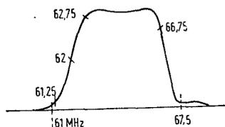
Fig. 17 — Curva di risposta complessiva delle sezioni RF e FI, rilevata dopo il secondo rivelatore. I numeri si riferiscono (per esempio) al canale italiano n. 1 (Monte Pénice). Come si vede, lo scalino del suono si
