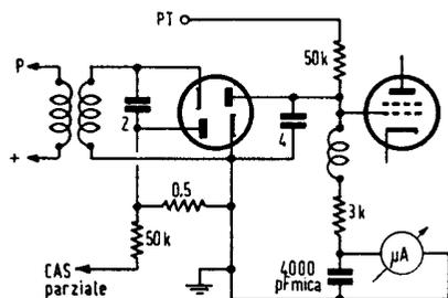
Fig. 19 — Come s'inserisce nel circuito un microamperometro per ottenere l'indicazione della corrente raddrizzata (componente continua). Vedi anche la fig. 90 e il relativo commento.
