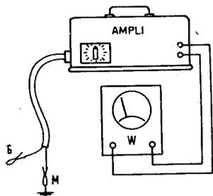
Fig. 93 — Dispositivo amplificatore col quale è possibile rilevare piccole ddp alternate. Può essere tarato per comparazione e può servire a valutare tensioni anche di pochi microvolt, se l'amplificazione è sufficiente e le precauzioni prese per la misurazione sono quelle dovute. Al posto del misuratore di uscita può essere inserito un oscilloscopio tarato, col quale è possibile anche analizzare (nella forma e nella frequenza) la ddp rilevata.
