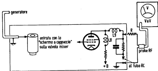
Fig. 102 — Collegamento per la misura del guadagno dell'amplificatore di FI e di quello video. Il VaV deve essere munito di « probe » RF. E' consigliabile interporre la resistenza R di circa  $10K \pm 20K$  ohm, come risulta dallo schema, e ciò per evitare che la capacità del « probe » influisca sensibilmente sulla risposta. Occorre, anche per questa misura, definire la profondità e la frequenza di modulazione, operando in un punto adatto della curva di risposta.
