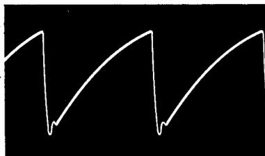
Fig. 35 — Forma del segnale esistente all'USCITA dello stadio OSCILLATORE ORIZZONTALE.
