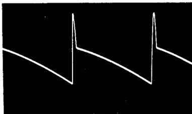
Fig. 34 — Forma del segnale esistente all'USCITA dello stadio di uscita VERTICALE. Valore di picco = 500 ÷ 900 V pp a seconda del tipo di valvola e di circuito.
