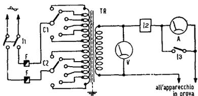
Fig. 88 — *Semplice dispositivo per il collegamento dell'apparecchio in prova alla rete di alimentazione a CA, col quale è possibile controllare e regolare la tensione di rete e la corrente assorbita dall'apparecchio sotto*
