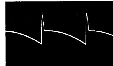
Fig. 37 — Forma del segnale presente nel circuito catodico della valvola «damper». Tensione di punta = 1500 ÷ 4800 volt (misurabile con oscilloscopio tarato, da collegare attraverso un partitore riduttore, con resistenza molto alta).
