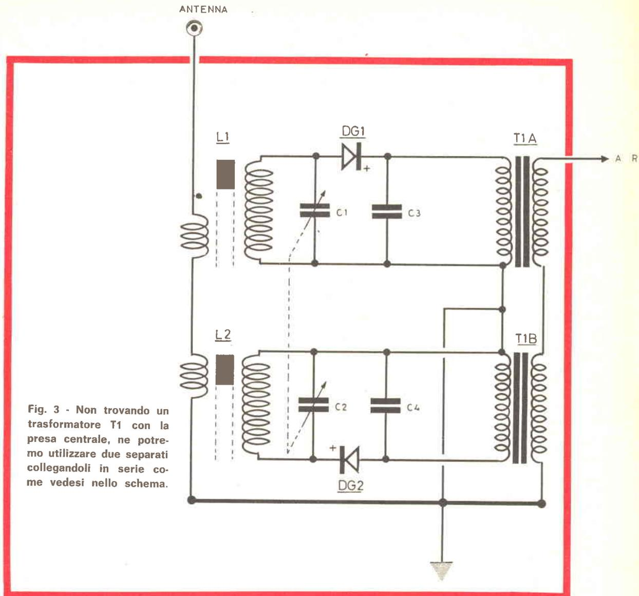
Fig. 3 - Non trovando un trasformatore T1 con la presa centrale, ne potremo utilizzare due separati collegandoli in serie come vedesi nello schema.
