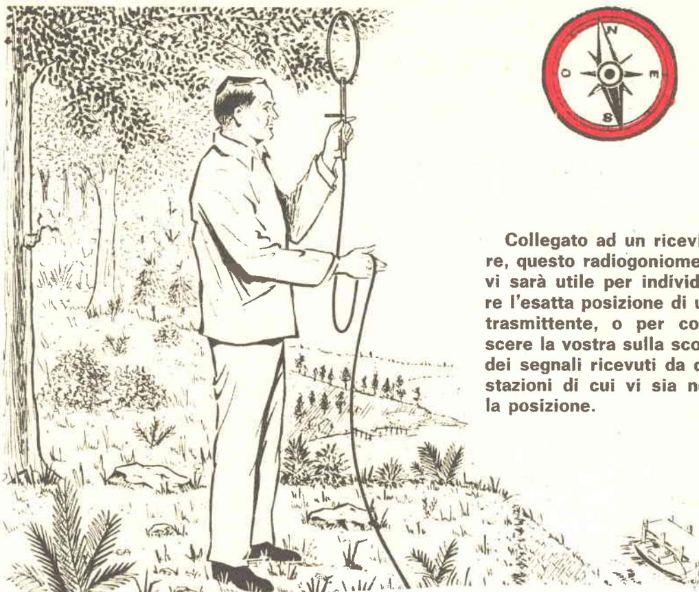
**Collegato ad un ricevitore, questo radiogoniometro vi sarà utile per individuare l'esatta posizione di una trasmittente, o per conoscere la vostra sulla scorta dei segnali ricevuti da due stazioni di cui vi sia nota la posizione.**
