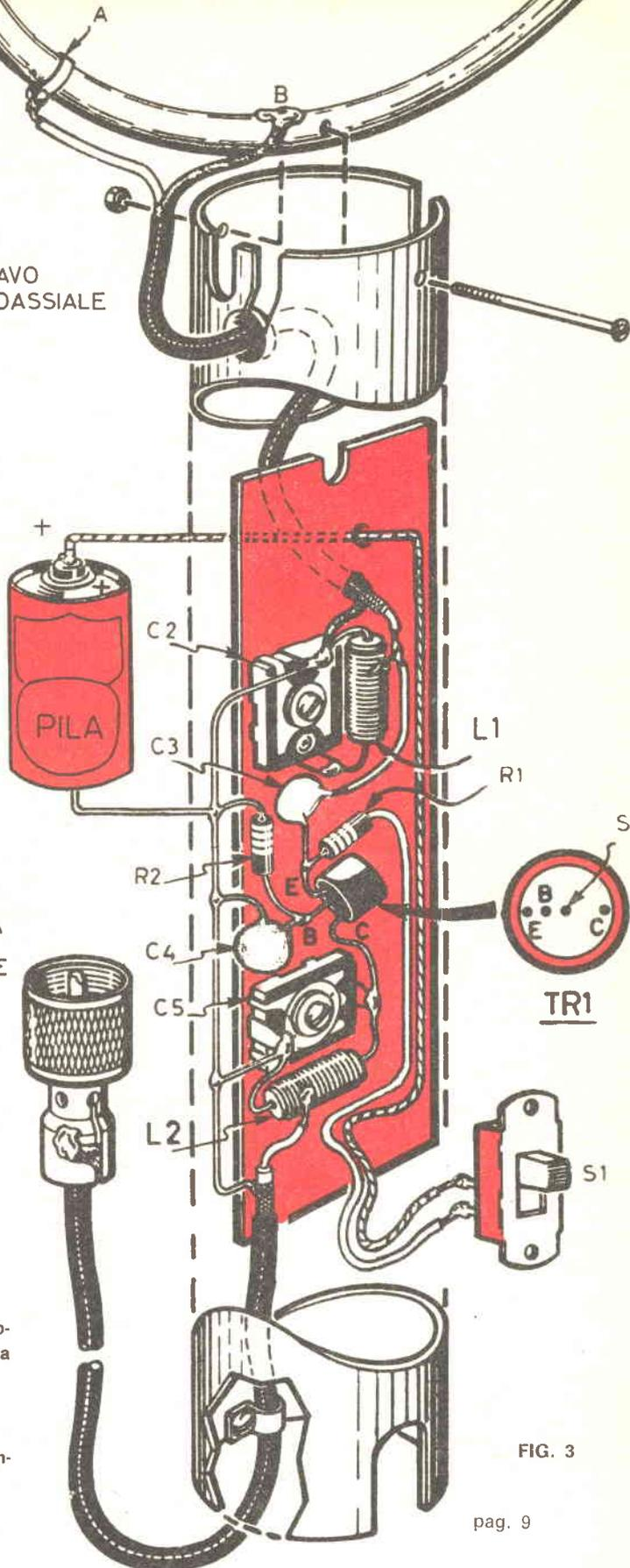
FIG 2 - Fotografia del radiogoniometro come si presenta a costruzione ultimata.
