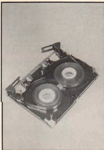
Fig. 29: Costituzione di un contenitore «Elcaset».
