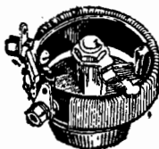
Fig. 8.10. - Aspetto del reostato di 30 ohm ( \Omega ) per la regolazione dell'accensione del filamento della valvola di fig. 8.9.
