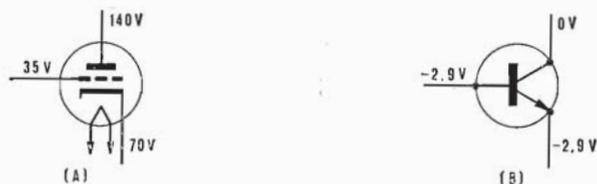
Figura 10-38. - Confronto delle tensioni elettrode in stadi amplificatori CAG: (A) a valvola; (B) a transistore.
