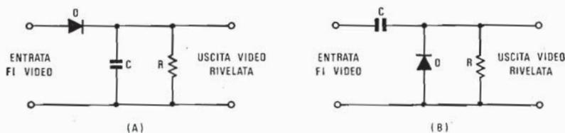
Figura 11-17. - Circuiti rivelatori video: (A) in serie; (B) in parallelo.
