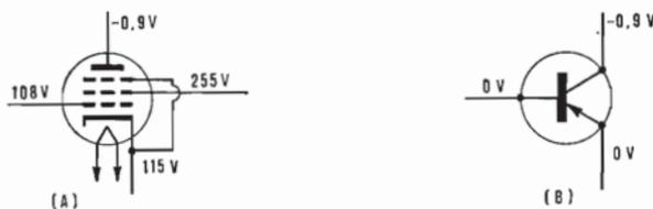
Figura 10-37. - Confronto delle tensioni elettrode fra due stadi CAG controllati ad impulso: (A) a valvola; (B) a transistor.
