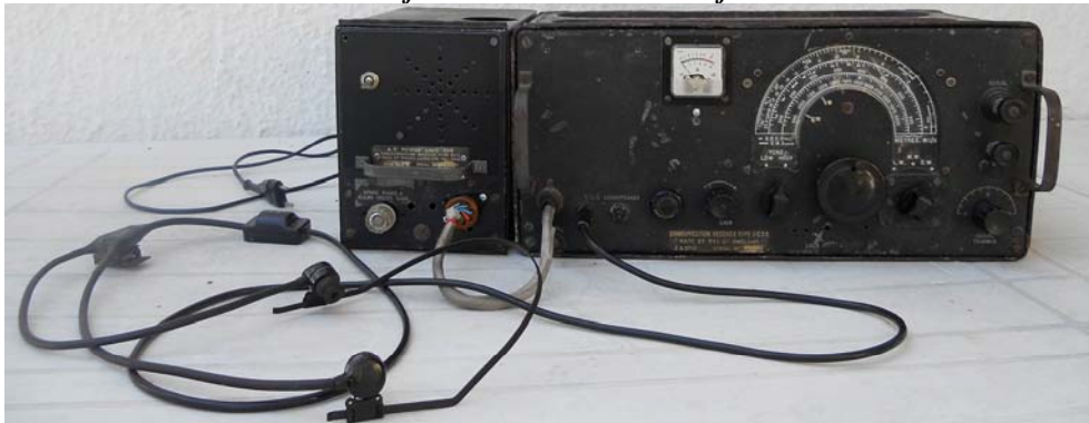
Fig.11- Il Ricevitore PYE PCR2 modificato
