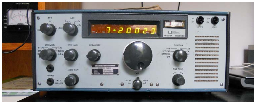
La foto qui sopra mostra il ricevitore Plessey PRI553A (con il display modificato) 3 .
