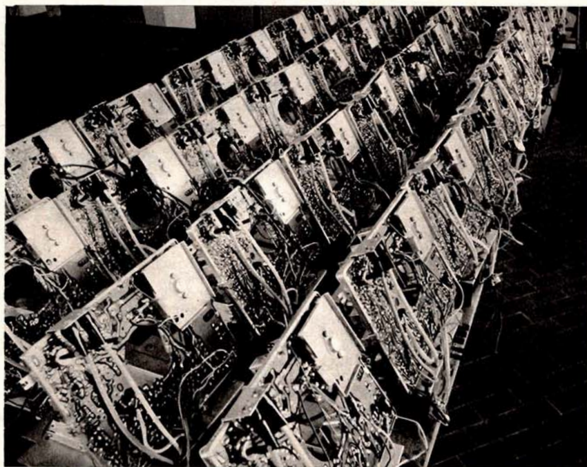
Gli chassis pronti per le successive operazioni: la ditta Prandoni produce televisori da 11, 12, 17 e 23 pollici, tutti transistorizzati.
