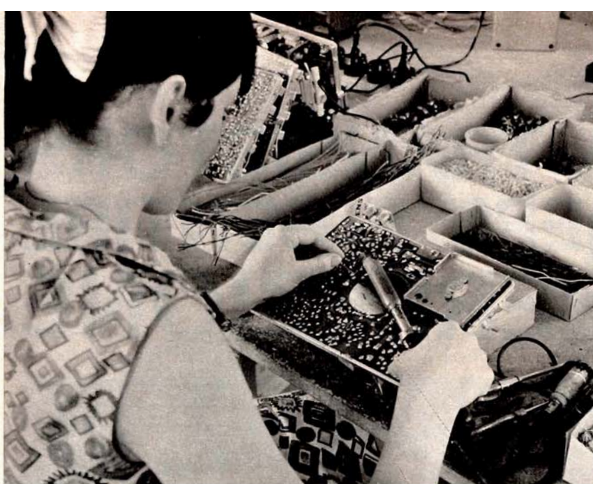
Centinaia di minuscole saldature occorrono nello chassis dei televisori: la lavorazione, di altissima precisione, viene eseguita completamente a mano.
