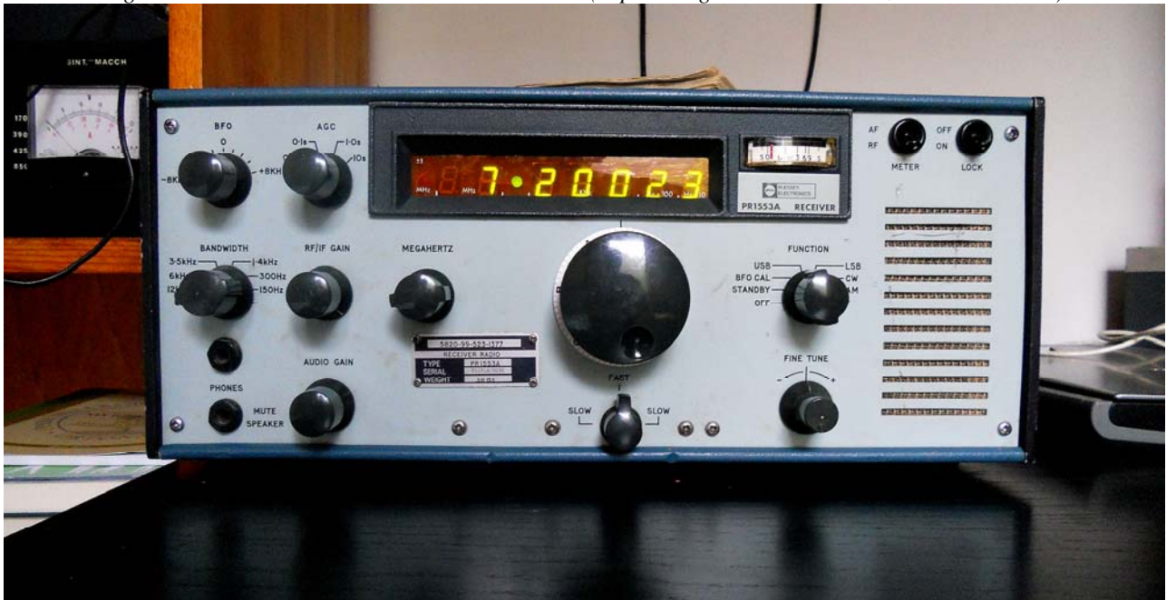
1) Foto del "PRI535A" modificato e funzionante con display a sette segmenti.
