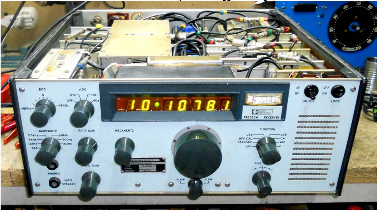
2) Il ricevitore senza il coperchio superiore. Da notare la complessità costruttiva interna dell'apparato.
