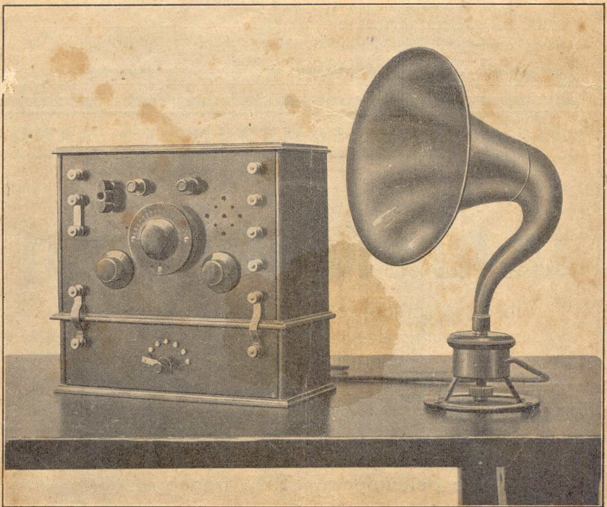
APPARECCHIO SUPERRIGENERATIVO AD UNA VALVOLA
