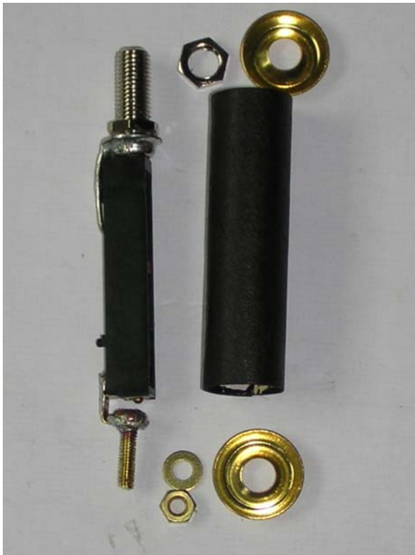
Fig. 40. I capicorda saldati sui contatti.
