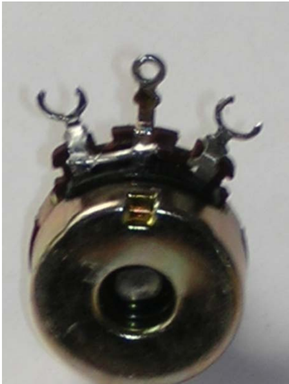
Fig. 24. I capicorda tagliati e la saldatura. .
