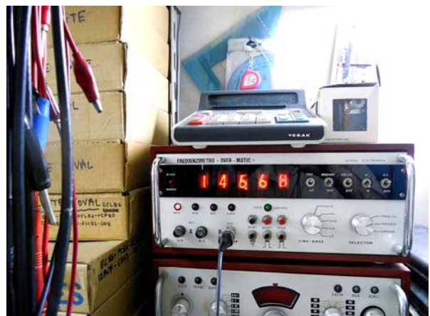
La frequenza emessa dal Grid-Dip (megacicliometro)
