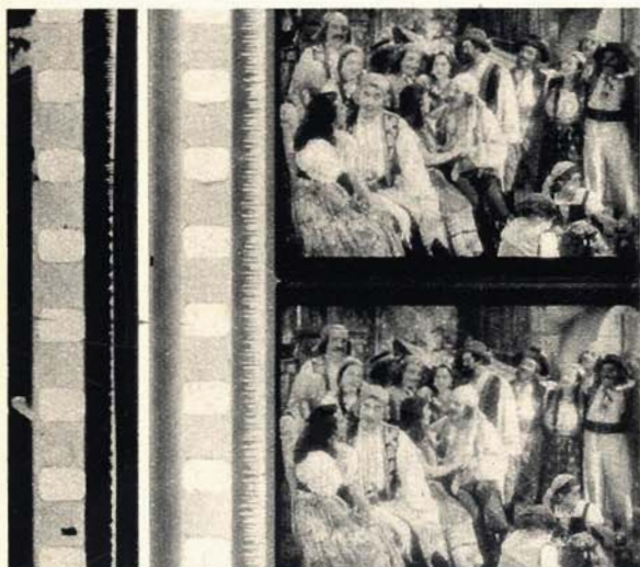
Colonne sonore a "semplice superficie variabile" con e senza copertura (unilaterale). Nella parte centrale della colonna di sinistra, là dove la strisciolina chiara si restringe, s'indovina una zona a suono debole.
