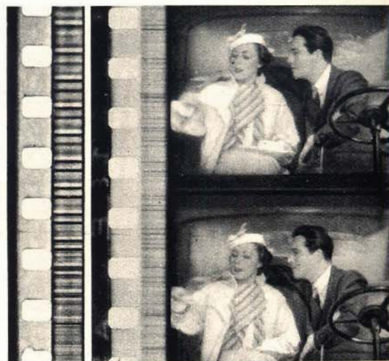
Colonne sonore a "densità variabile" con e senza copertura. La velatura che si nota nella parte centrale della colonna di sinistra denuncia una zona a suono debole che è stata "coperta" appunto per attenuare i rumori "di fondo". La colonna di destra, così fortemente schiarita, non può non dar luogo ai rumori "di fondo". La strisciolina bianca che taglia longitudinalmente la colonna, un po' a sinistra, è dovuta ad una "patinatura".
