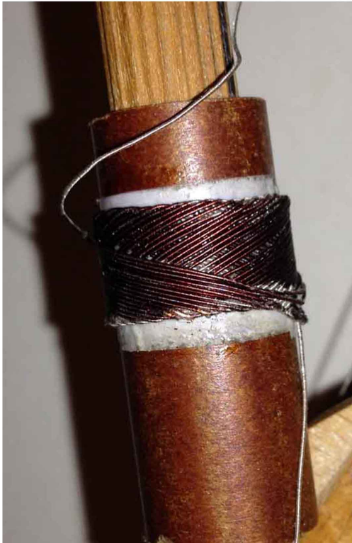
Fig. 4 Il primo strato dopo la laccatura
