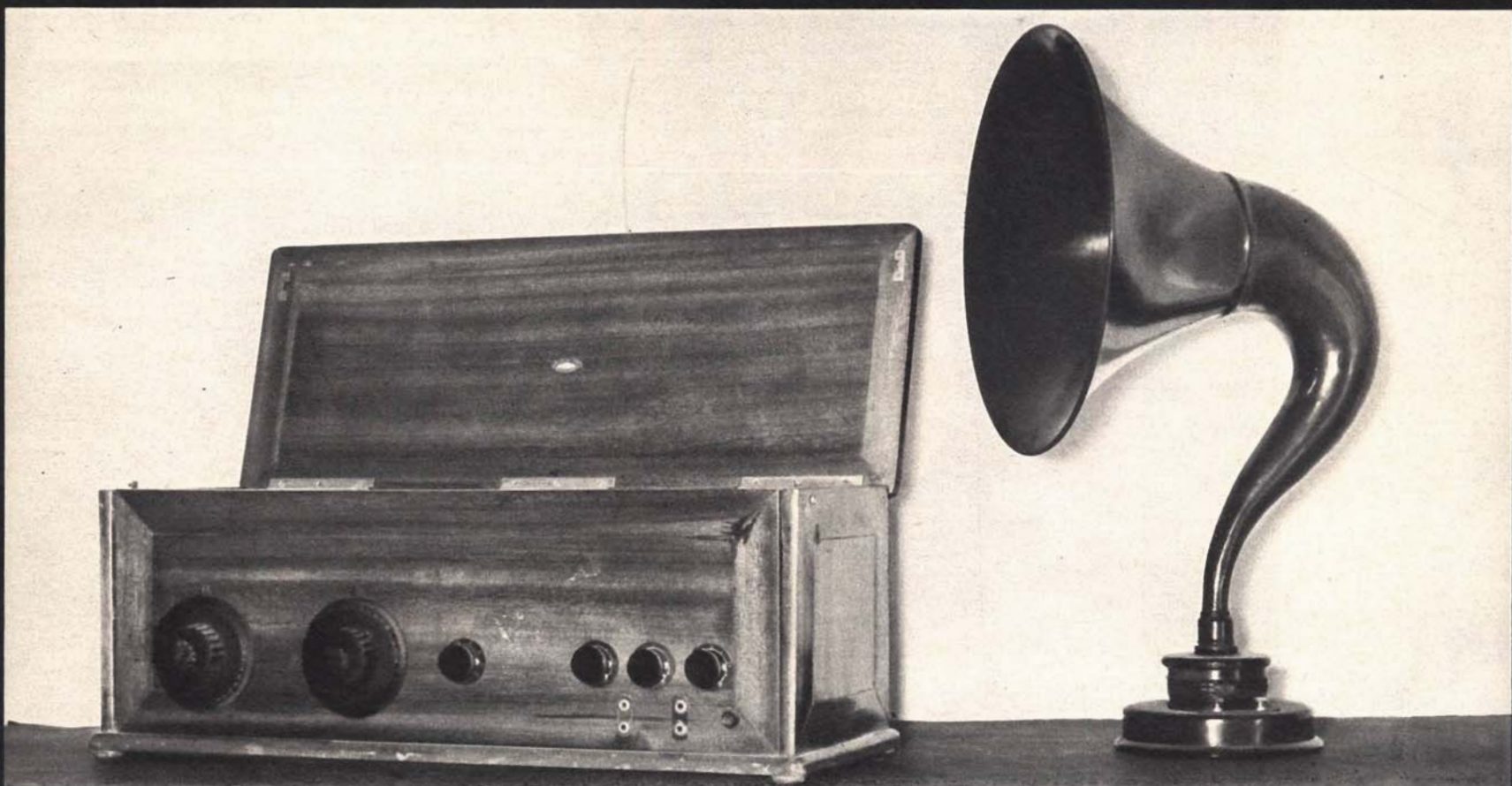
UN ALTOPARLANTE A TROMBA, definito allora del tipo "Gran Concerto", costruito nel 1924. Ricorda le trombe dei grammo-foni a manovella,
