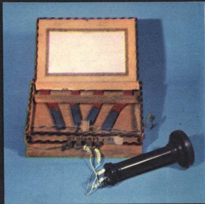
IN UNA SCATOLA di sigari Marconi costruì il "detector magnetico", usato fino all'avvento della valvola termoionica.
