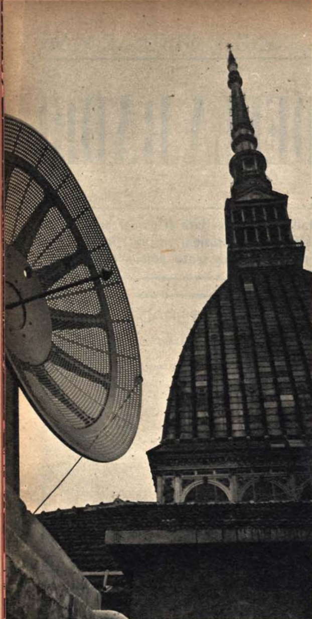
La stazione radio di Torino ha già sperimentato felicemente la televisione. Questa scodella è un sistema irradiante e ricevente per ponti radio.
